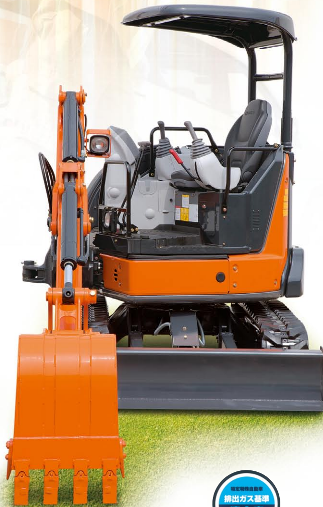
ZAXIS 30U 2柱キャノピ オプションの追加カウンタウエイト付き
