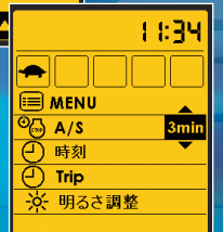
オートアイドル リングストップ 時間切替え表示 (オプション)
