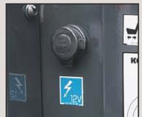
12V外部電源取出口
