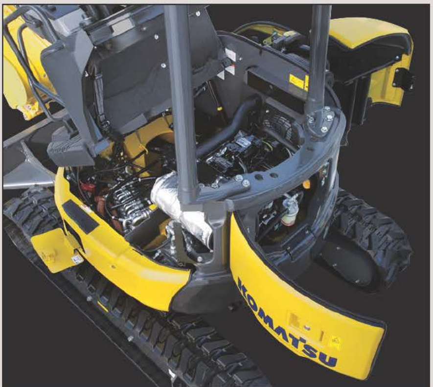
キャノピ仕様のチルトアップフロア機構&フルオープンカバー
