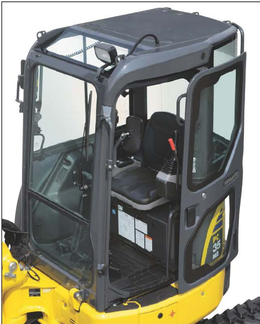
旋回時にキャブが履帯から PC30MR-3 : 110mm、PC35MR-3 : 80mmはみ出ます。
